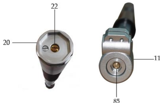
(20) BOUCHON DE FOURCHE (11) PIED DE FOURCHE (22) REGLAGE DE DETENTE (85) REGLAGE DE COMPRESSION
