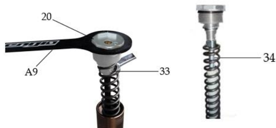
(20) BOUCHON DE FOURCHE (33) ECROU (34) TIGE DE DETENTE (A9) ENGI-FCW
