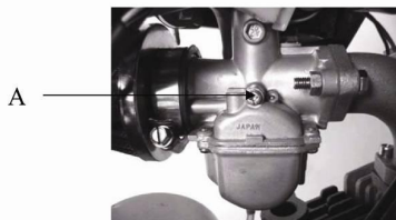
(A) Vis de réglage pour le ralenti
