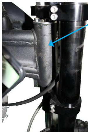
2- Numéro de série situé à l'avant du cadre
